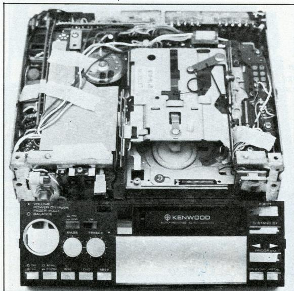
*La maggior parte dello spazio è occupata dalla pregevole meccanica di trascinamento del nastro, la sezione tuner è a ridosso del pannello posteriore.*
